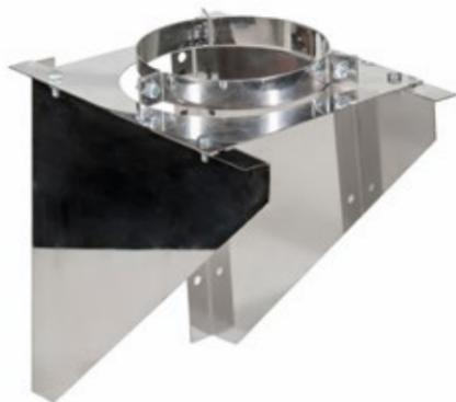
Опора сквозная с кронштейном ОСК не является несущим силовым элементом. Состоит из двух кронштейнов с монтажными отверстиями и опоры сквозной ОС. Кронштейны жестко закрепляются на стене здания и выполняют функцию опорных элементов.
