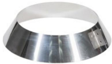
Фартук (Ф) - вспомогательный (фасонный) элемент дымоходной системы. Помимо декоративной функции, используется в качестве завершающего элемента для защиты от попадания осадков в зазор между трубой дымохода и конусом кровельного элемента КЭ. Фартук (Ф) представляет собой усеченный конус из нержавеющей стали. Не имеет сварного шва, края стягиваются при помощи болтов гаек. Фартук относится к ОБЩИМ элементам, так как не имеет типовой принадлежности.
